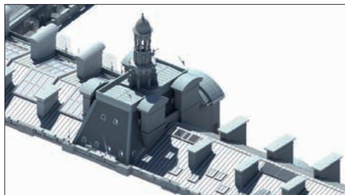
Modèle Bim "tel que construit" des toitures du Musée du Louvre (Paris) d'après un relevé en 3D par Art graphique et patrimoine, numérisation qui a remporté un "coup de cœur" du jury aux Bim d'or 2019.
