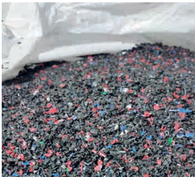
Une fois récupérés, les tuyaux sont triés et broyés pour être ensuite reconstitués.
