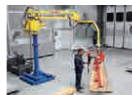
Dispositif pour faciliter la manipulation de tous types de structures en bois.
