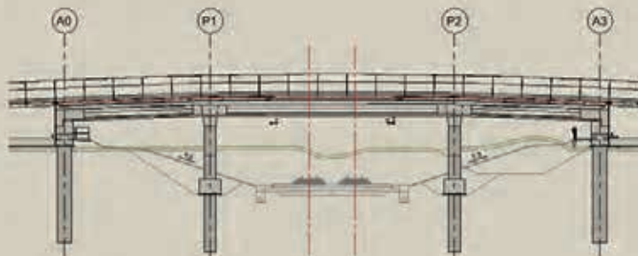
2c- Tablier à une travée intégral sur culées (portique)
