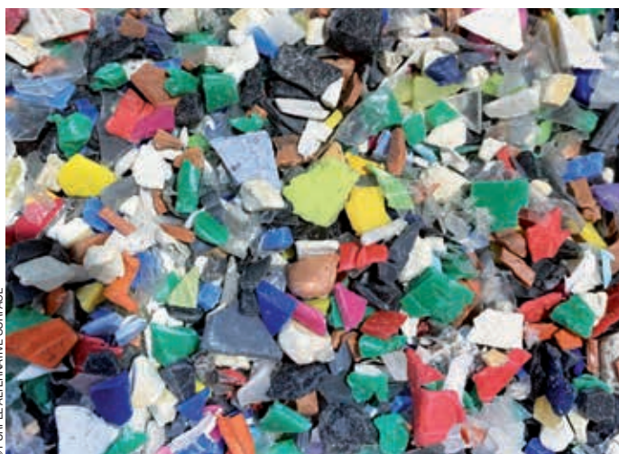
Broyat de plastiques et composites provenant de déchetteries et de l'industrie sont les matières premières des dalles perméables purple.
