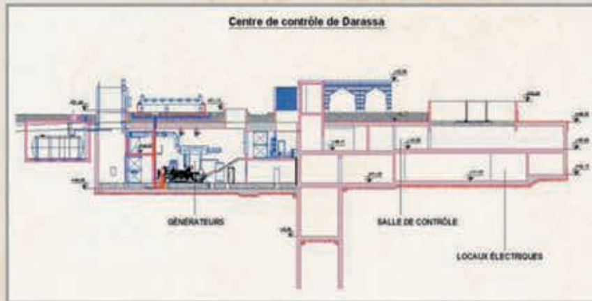
Figure 6 Coupe longitudinale avec générateurs et aérorefrigerants Longitudinal section with generators and air coolers
