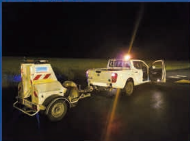
Essais HWD sur des chaussées aéroportuaires > aéroport - Guyane
