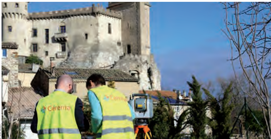
Relevés réalisés par le Cerema pour mettre évidence d'éventuels mouvements millimétriques sur l'éperon rocheux, base d'un château ardéchois.
