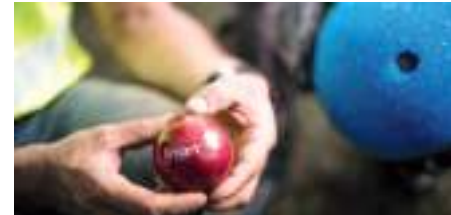
La Smartball contient une batterie de capteurs et appareils de mesure. À droite, sa protection en mousse bleue.
