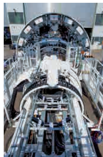
Le tunnelier Serena (6,85 m de diamètre), ici chez d'Herrenknecht, a creusé 14 km du tunnel de reconnaissance du Brenner Tunnel entre l'Autriche et l'Italie.
