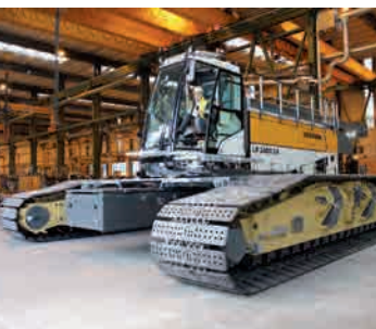
La LR 1400 SX peut lever jusqu'à 400 tonnes.
