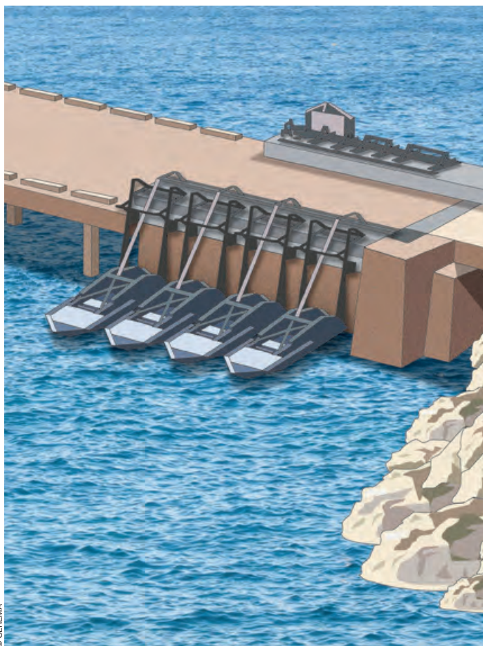
Dessin du système houlomoteur Eco Wave Power à deux fois 4 flotteurs pilonnants, connecté au réseau en 2016 sur la jetée à Gibraltar (Royaume-Uni).
