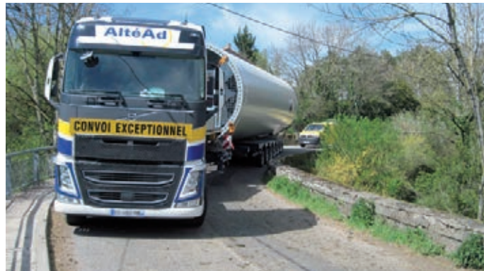
Viasagax (Freysinet) qui pèse les camions en entrée de pont et lit leur plaque d'immatriculation, est expérimenté dans l'Hérault.
