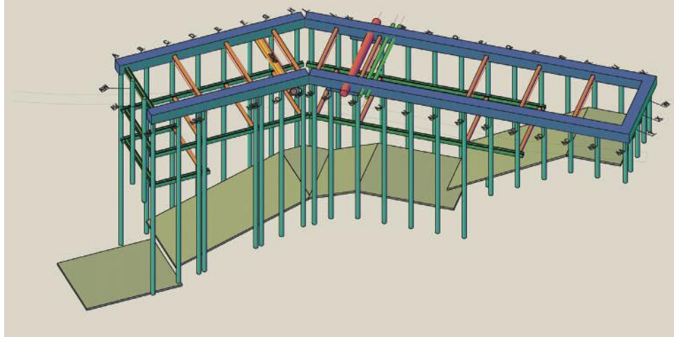
BUTONNAGE DE LA TRANCHÉE
