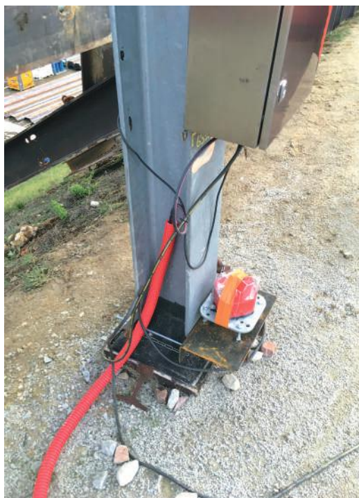
Deux des 7 capteurs (boîte rouge) qui ont suivi le battage d'un rideau de palplanches au bord d'une voie ferrée à Perdreaux (Yvelines), afin de respecter l'instruction IN1226 de la SNCF sur les vibrations.
