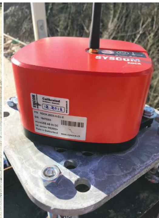
Deux des 7 capteurs (boîte rouge) qui ont suivi le battage d'un rideau de palplanches au bord d'une voie ferrée à Perdreaux (Yvelines), afin de respecter l'instruction IN1226 de la SNCF sur les vibrations.
