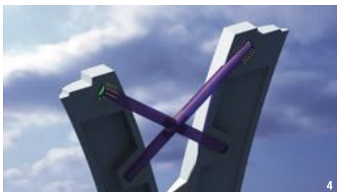
CONTREVENTEMENT DES PILES DU VIADUC DE LA SAÔNE
