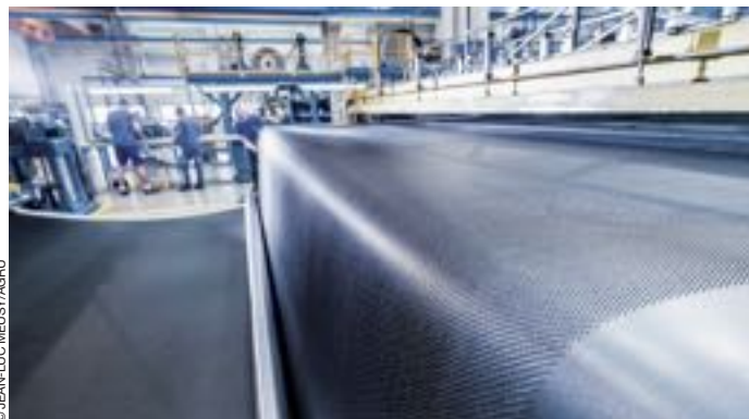
Production d'une géomembrane structurée en PEHD (Autriche), 2 de photo primée.
