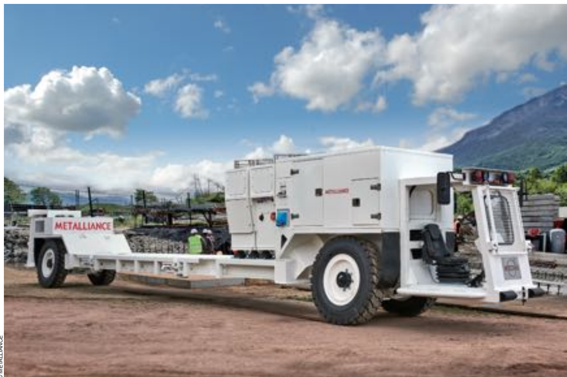
Engin d'alimentation de tunnelier fonctionnant sur batteries électriques.
