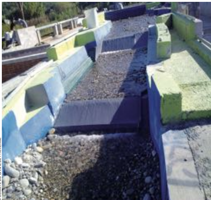
Modèle réduit du barrage pour étudier sa réhabilitation en simulant des crues avec des seuils en plans inclinés.
