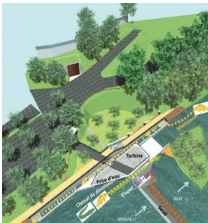
Plan du réaménagement du seuil à terme. À noter les passes à poissons vers l'amont et vers l'aval.
