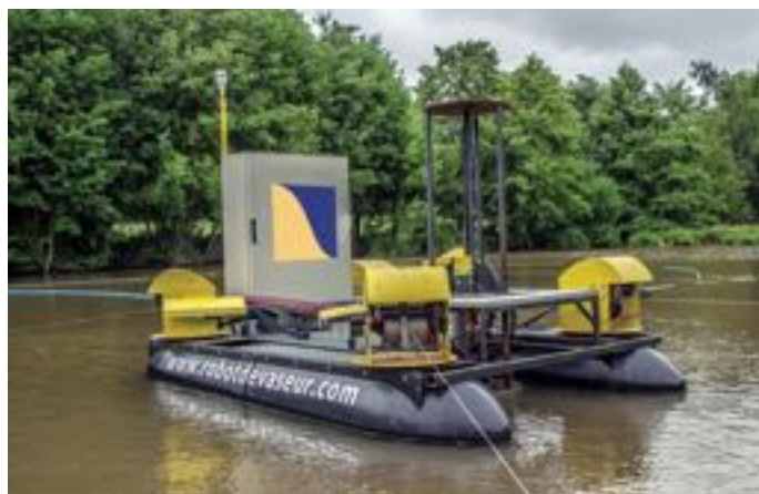
Prototype du robot dévaseur conçu pour draguer de petites quantités de sédiments, souvent.
