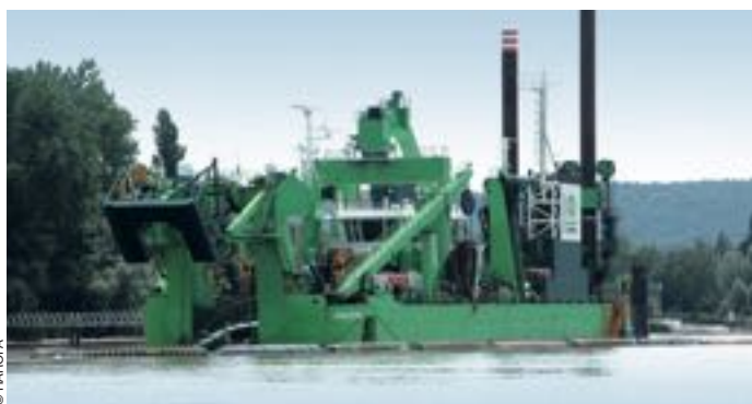
Drague stationnaire à désagrégateur pour refoulement des sédiments sortis de la Seine vers la ballastière d'Yville (Seine-Maritime) à combler.
