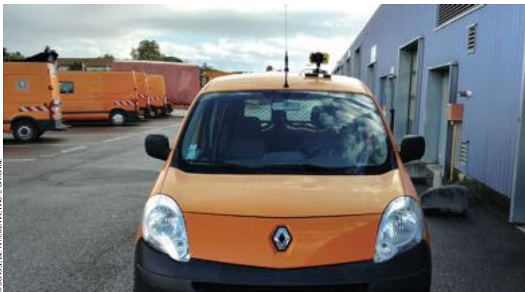
Un smartphone, fixé sur le toit d'un véhicule du Conseil départemental de Haute-Garonne, filme la route. Les données servent à prédire l'entretien.
