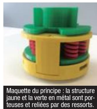
Maquette du principe : la structure jaune et la verte en métal sont porteuses et reliées par des ressorts.
