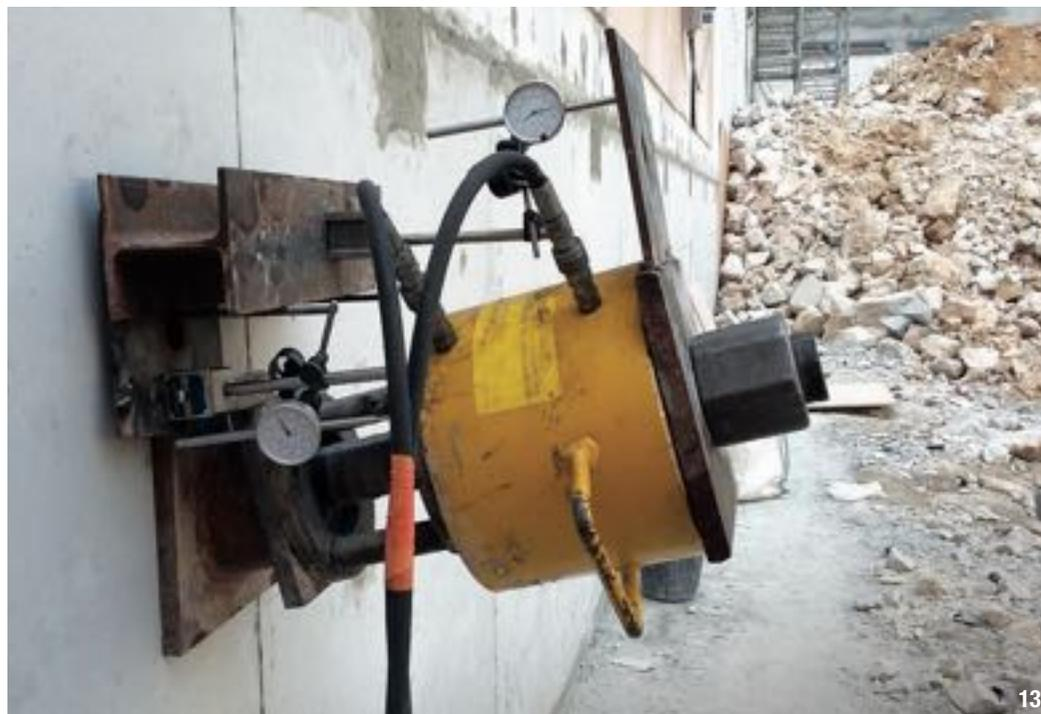
**13- Essai de contrôle de clou.**
