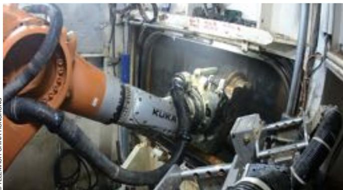
Ce bras robot peut remplacer une molette usée sur un bouclier de tunnelier.
