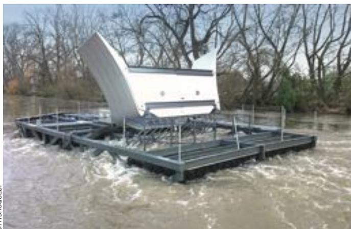
En blanc, l'hydrolienne en test sur la Loire à Orléans (Loiret) sortie de l'eau pour maintenance : une fois ré-immersée, sa partie la plus étroite (en bas ici) fait face au courant, ses ailerons placés comme des nageoires.
