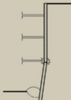
RUPTURE D'UN ÉCRAN AVEC APPUIS MULTIPLES
