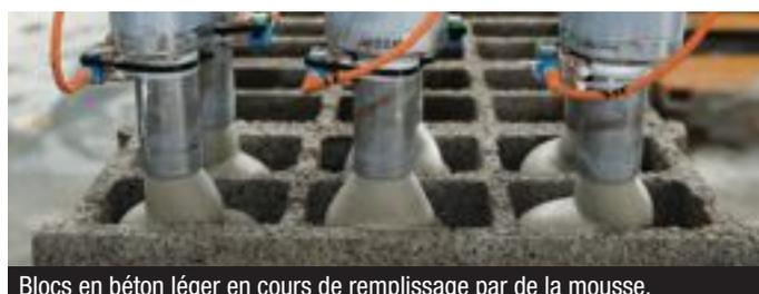
Blocs en béton léger en cours de remplissage par de la mousse.
