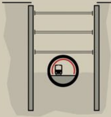
Paroi moulée et excavation autour des anneaux sous exploitation
