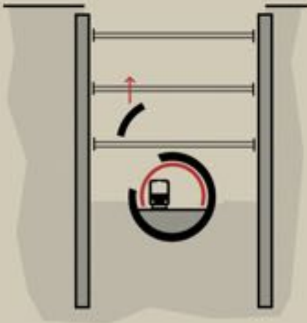
Découpe et évacuation des anneaux de voussoirs sous exploitation
