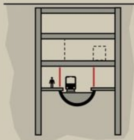
Réalisation du second œuvre, des installations électriques et mise en service
