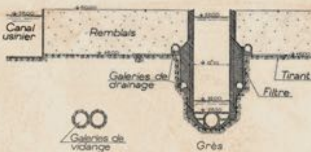
Fig. 30. — Ecluse. Coupe transversale.
