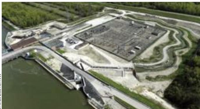
À gauche, en Y, les entrées de la passe à poissons avant la micro centrale (toits blancs) puis la rivière qui conduit les migrateurs jusqu'à la sortie.
