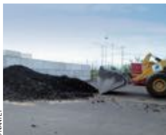
La transformation de déchets de membranes d'étanchéité donne des granulats, combustibles solides.
