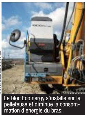
Le bloc Eco'nergy s'installe sur la pelleuse et diminue la consommation d'énergie du bras.
