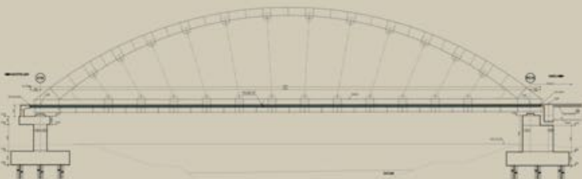
BOW-STRING - COUPE LONGITUDINALE DANS L'AXE DE L'OUVRAGE
