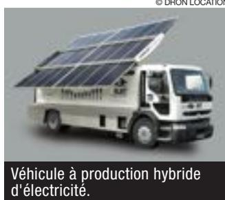
Véhicule à production hybride d'électricité.
