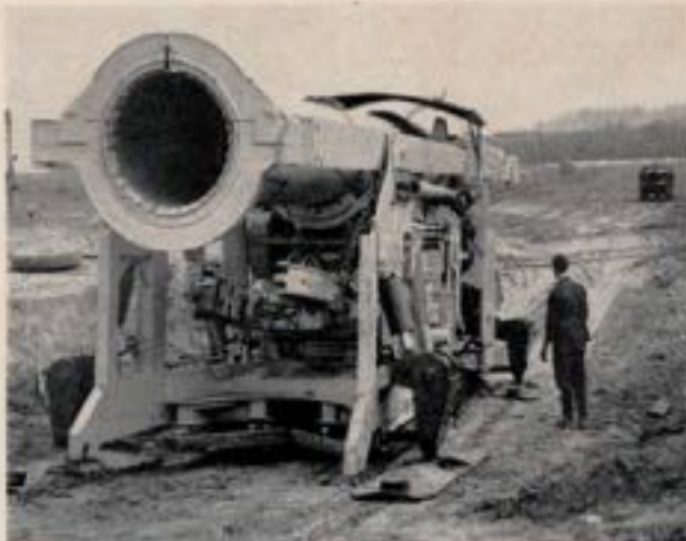
FIG. 5. Nouvelle machine de forage « Benoto » 1955, type E.D.F. (état du slope 10° de déplacement « Otario »).
