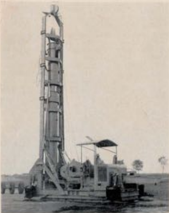
FIG. 2. — Nouvelle machine de forage « Benoto » 1955, type E.D.F. (position de travail).
