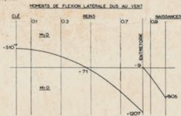
Fig. 10. — Efforts créés par le vent à 350 kg/m².
