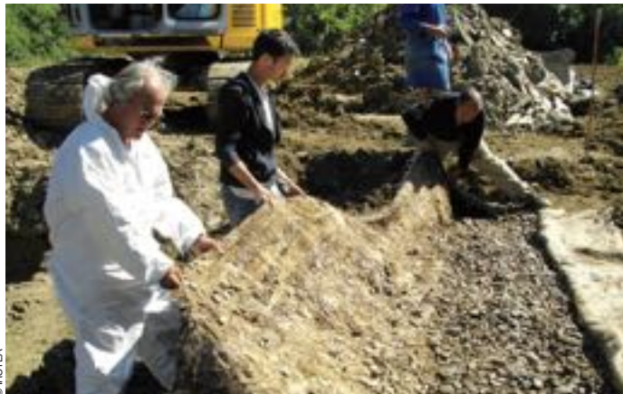
L'Institut de recherche en sciences et technologies pour l'environnement et l'agriculture prélève des géotextiles pour observer leur évolution dans le temps.
