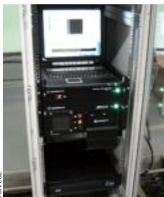
Baie d'acquisition des données relevées par la fibre optique et poste de commande du système.
