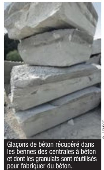
Glaçons de béton récupéré dans les bennes des centrales à béton et dont les granulats sont réutilisés pour fabriquer du béton.
