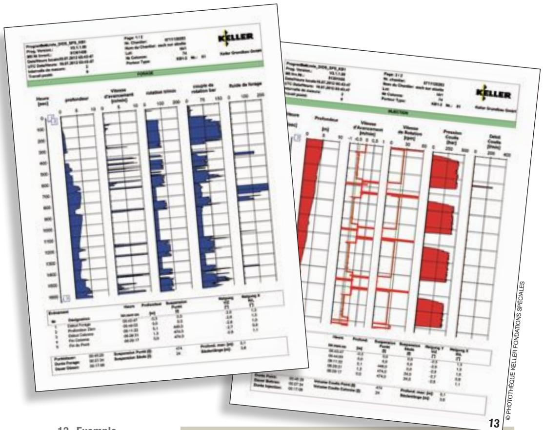
13- Exemple de fiche d'enregistrement de paramètres système Keller M5.
