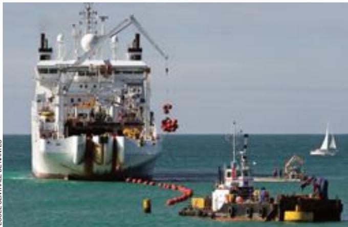
Le navire câblé René Descartes de France Télécom part dérouler le câble électrique sur le fond marin.
