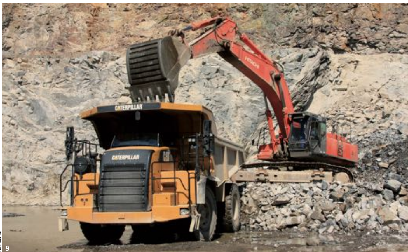
9- Le tombe-reau rigide Caterpillar 772 récemment mis en service dans la carrière de la Mouzinière au Château d'Olonne en cours de chargement par une pelle hydraulique Hitachi ZX 650 LCH.
