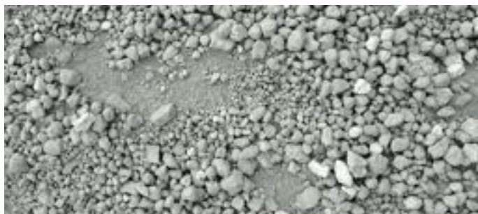
L'Écoforme composé de particules fines et gravillons nobles récupérés dans des boues de béton et de chantier.
