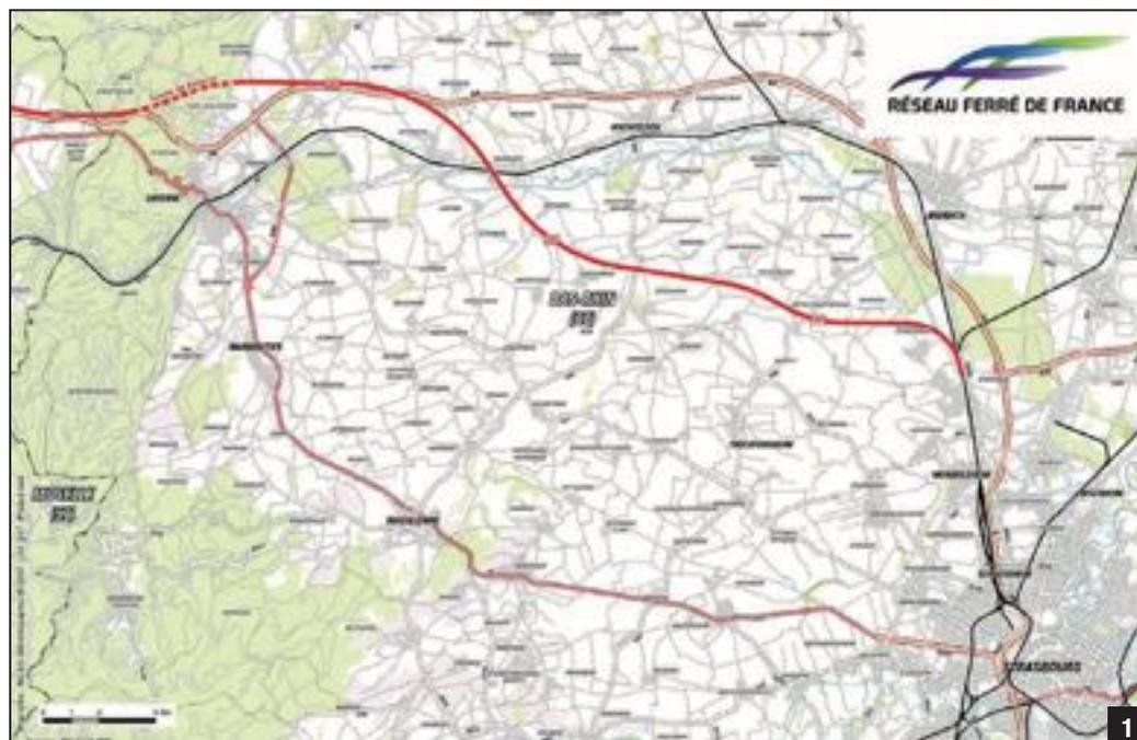
en tunnel (tunnel de Saverne) le massif vosgien dans sa partie la plus étroite. L'ouvrage souterrain bitube d'environ 4 km de long assure la liaison entre le piémont occidental des Vosges et la plaine d'Alsace. Il débouche au nord de Saint-Jean-Saverne. Puis le tracé s'infléchit au Sud
