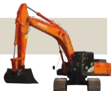
La pelle hydraulique Hitachi Zaxis 350LC-5.
