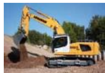
La pelle sur chenilles Liebherr R 950 SME (Super Mass Excavation) de 44 t.
