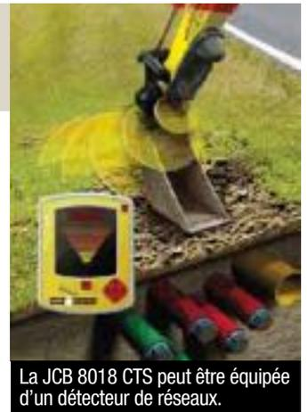
La JCB 8018 CTS peut être équipée d'un détecteur de réseaux.
