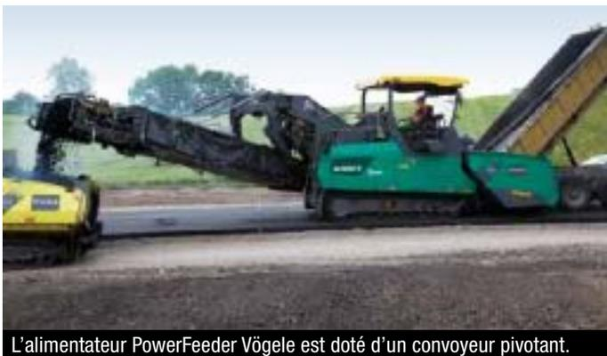
L'alimentateur PowerFeeder Vögele est doté d'un convoyeur pivotant.
