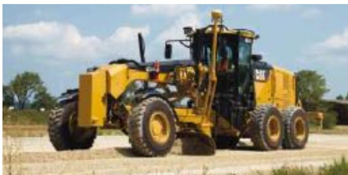
Caterpillar installe sur les niveleuses série M2 un moteur Tier 4 interim/Stage IIIB.
