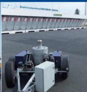
Essais HWD aéroport > TOGO
