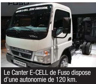
Le Canter E-CELL de Fuso dispose d'une autonomie de 120 km.
