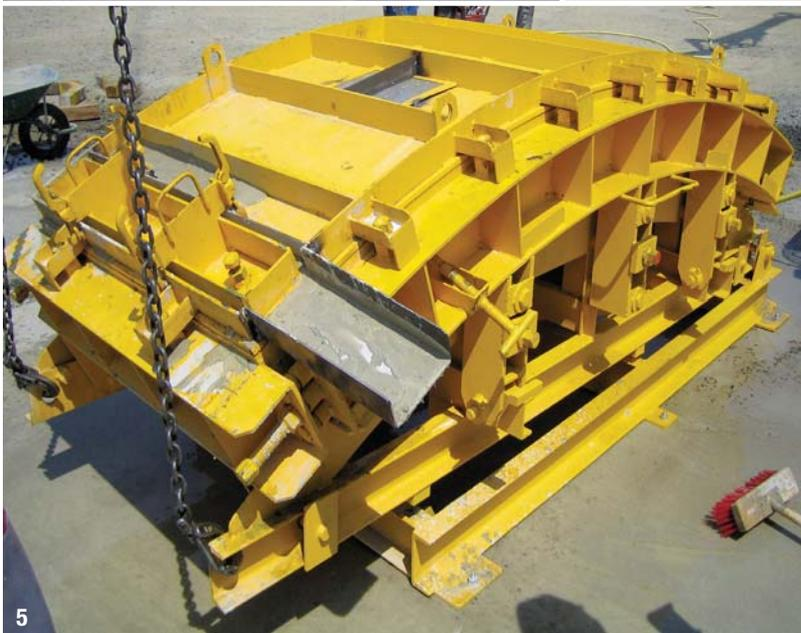
**3- Moule prototype en position de bétonnage – on distingue sur la photo le point d'injection du béton ainsi que deux fenêtres en plexiglas (prototype uniquement) permettant de visualiser le remplissage du béton.**
