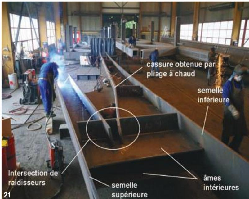
**21- Palme en cours d'assemblage et de soudage en atelier (les âmes extérieures ne sont pas encore assemblées, la pièce est couchée).**
