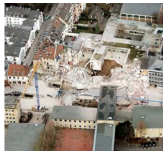
Effondrement du bâtiment des Archives à Cologne le 4 mars 2009, dans le cadre du projet de métro en cours de réalisation à proximité. En cause, des arrivées d'eau en fond de fouille qui ont déstabilisé le terrain encaissant et provoqué l'effondrement de la fouille.
