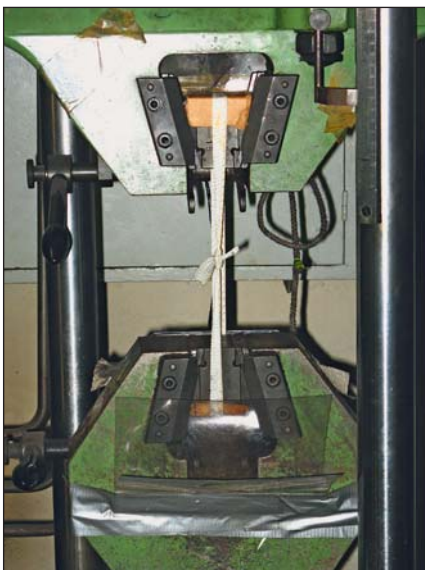
Photo 4 Essais de traction des ligatures Tie tensile tests
