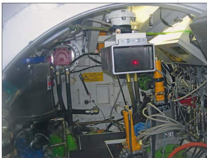
Photo 10 Cible active embarquée à l'arrière de la machine Active target mounted on the rear of the machine
