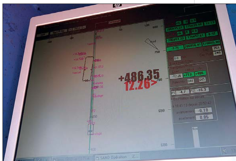
Photo 5 Placement de la plate-forme sur écran Platform positioning on screen
