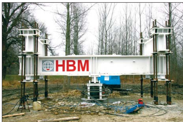
Photo 3 Essai de chargement de pieu à 15 000 kN à Budapest Pile loading test at 15,000 kN in Budapest
